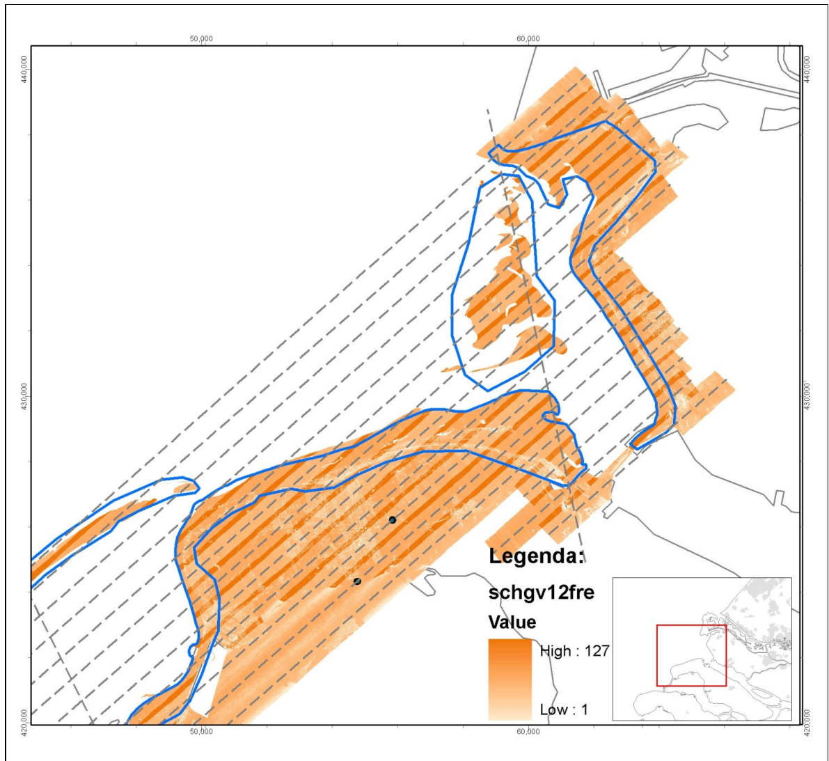
Figuur 3.3c: Frequentiegrid van de gefilterde laserdata van Oostvoorne en het noordelijk deel van Goeree.
