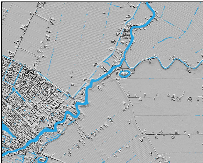
Figuur 4.5a: Voorbeeld van een ruwe hillshade met het azimut haaks op de strookrichting.
