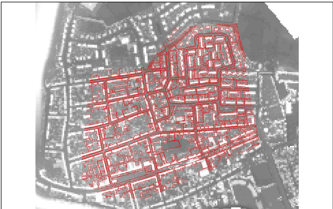
Figuur 3.6: Voorbeeld van een planimetrische controle: controle met een GBKN uitsnede in Westkapelle (deelgebied Zeeland), in rood de GBKN-vectordata met als ondergrond het grid.
