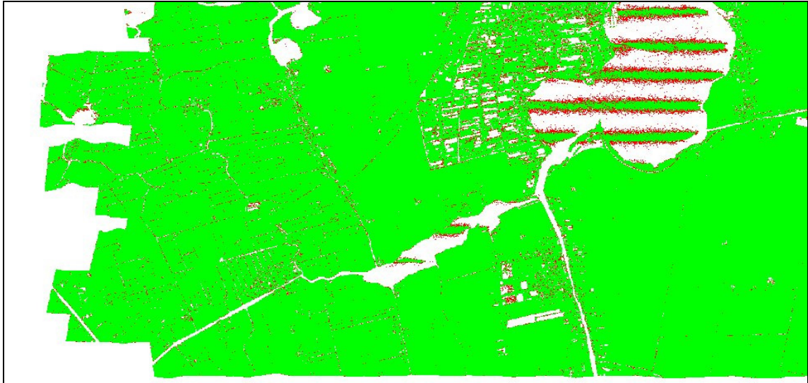
Figuur 4.3: Voorbeeld van een punt dichtheidsgrid. Een groene kleur betekent dat de gridcel voldoet aan de punt dichtheidseis, een rode kleur betekent dat de gridcel niet voldoet aan de punt dichtheidseis.
