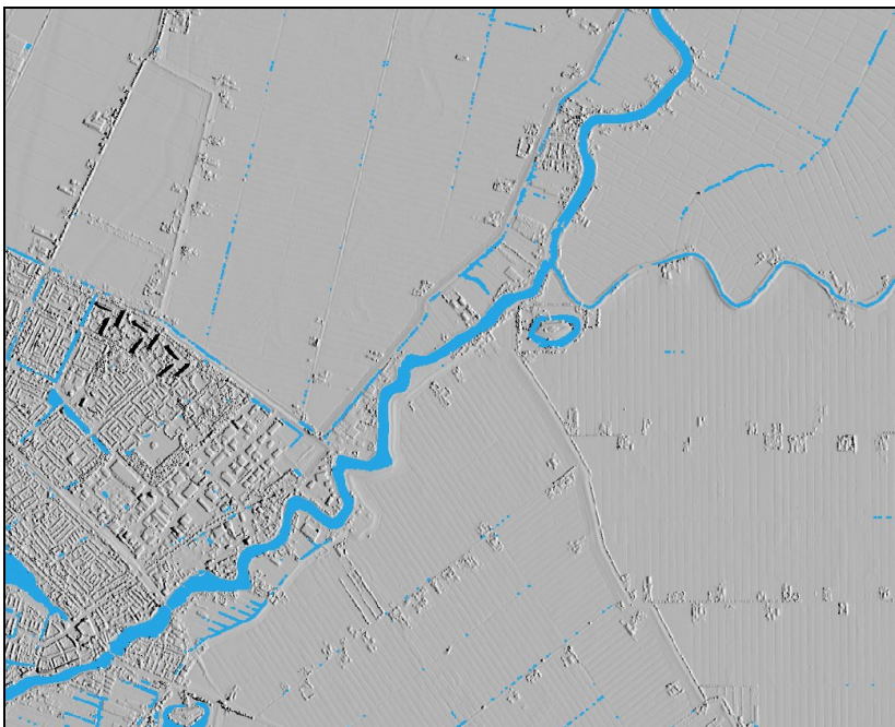
Figuur 4.5b: Voorbeeld van een ruwe hillshade met het azimut parallel aan de strookrichting.
