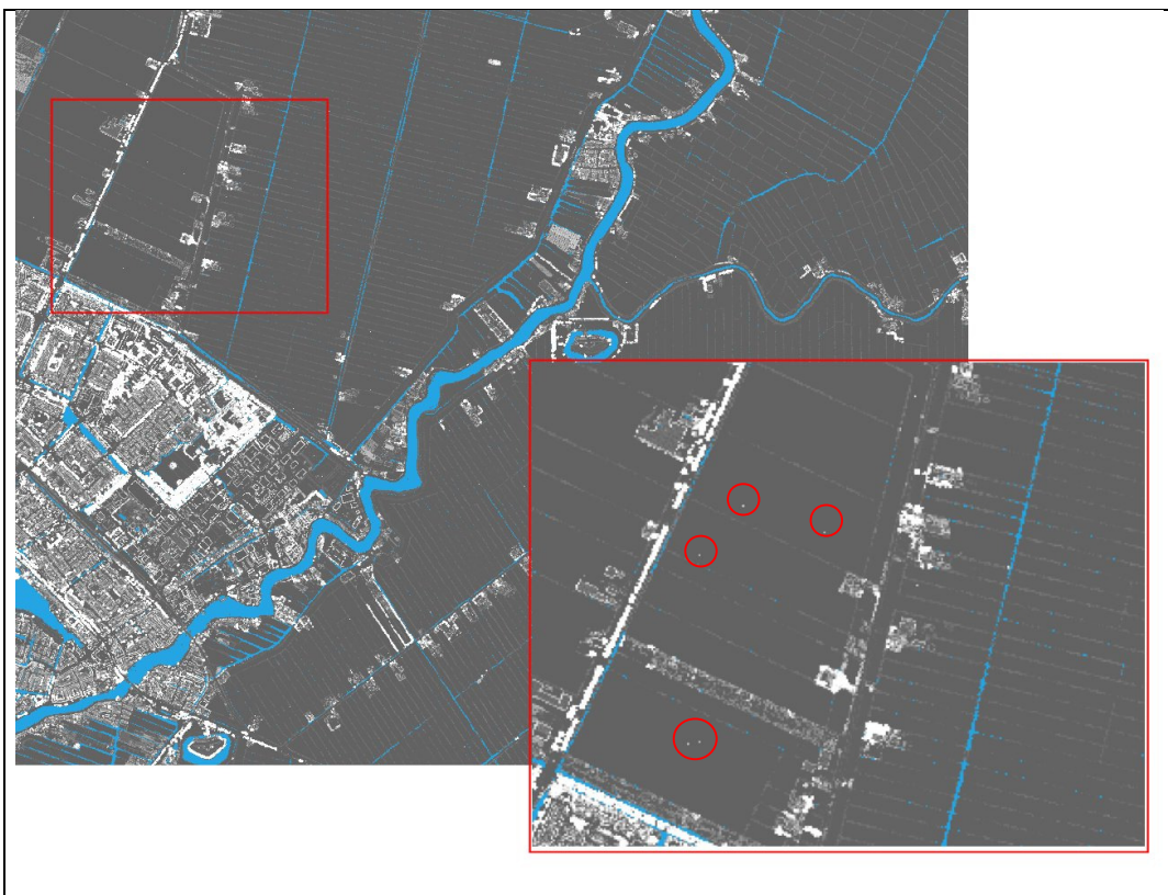
Figuur 4.7: Voorbeeld van een RMS grid met een detail waarin uitschieterende waarden duidelijk als witte puntjes in een egaal grijze ondergrond te zien zijn.
