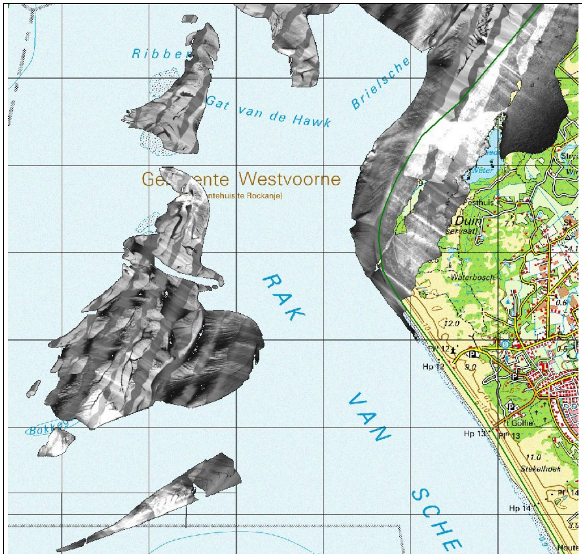
Figuur 3.3: Voorbeeld van de frequentie van de laserhoogtedata van het projectgebied Voordelta 2007, vóór filtering. Hoe lichter de kleur, hoe hoger de frequentie van punten. Het betreft een deel van het gebied ten westen van Voorne. In groen is de gevraagde projectgrens aangegeven.
