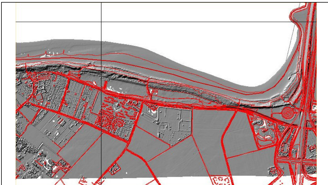
Figuur 3.6: Voorbeeld van een planimetrische controle: controle met een GBKN uitsnede, in rood de GBKN-vectordata met als ondergrond het grid.
