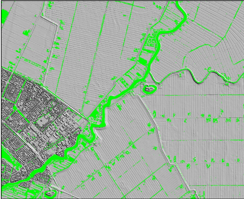
Figuur 5.2a: Voorbeeld van een gefilterde hillshade met het azimuth haaks op de strookrichting.
