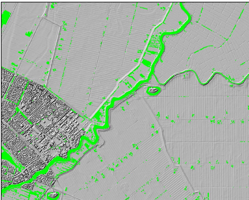
Figuur 5.2b: Voorbeeld van een gefilterde hillshade met het azimuth parallel aan de strookrichting.
