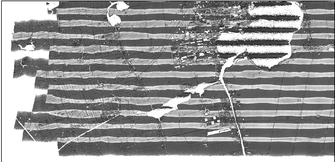
Figuur 4.1: Voorbeeld van een frequentiegrid. Hoe lichter het grid van kleur is, hoe hoger de frequentie. De geheel witte delen zijn no-data gebieden.
