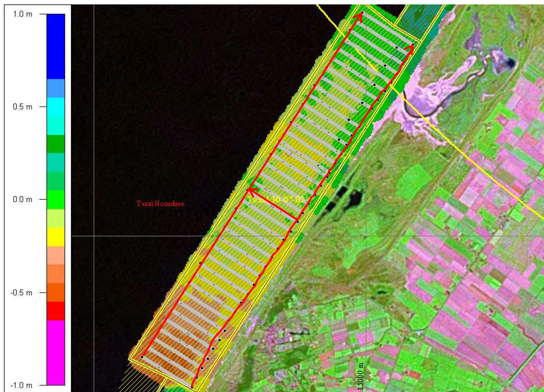
Figuur 4 Verschilplot tussen LRK en WST (25x25 meter Surfer grid). Rode lijnen zijn profielen
