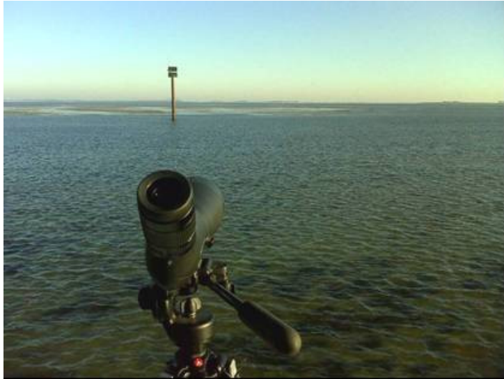
Figuur 14. Uitzicht van de waarnemer met een telescoop op de voorgrond en de meetplaat de Argus. De waarneemhoogte vanaf de stuurhut is ca. 6,2 meter boven het slik.
