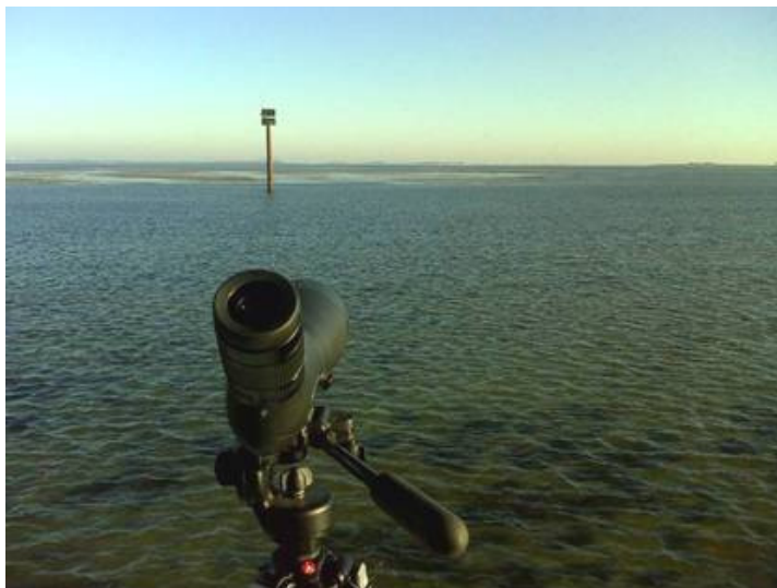
Figuur 14. De waarneemhoogte vanaf de stuurhut is ca. 6,2 meter boven het slik.
