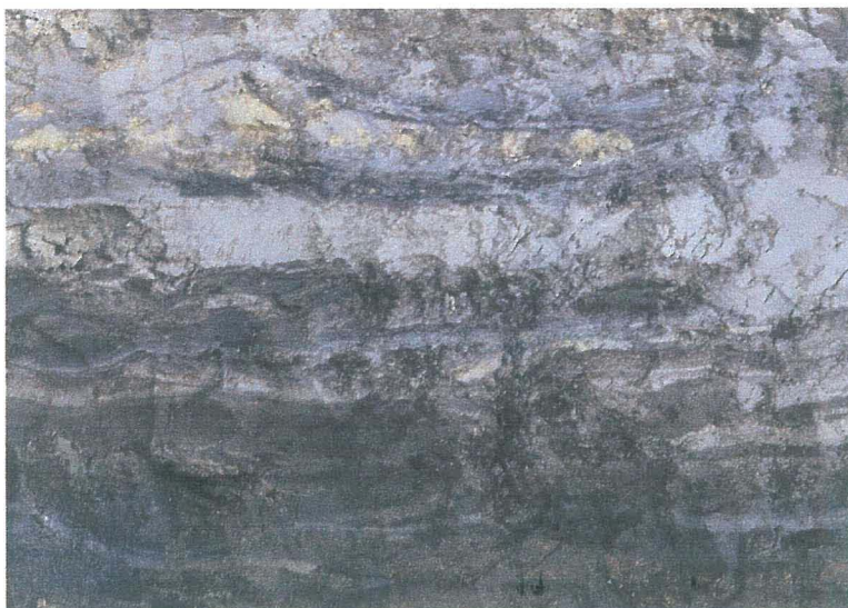
Foto 3 : Detail uit de profielwand. Terpophoging bestaande uit: 1. plaggen Tinga klei en Tinga veen en 2. uit grijze kwelder-plaggen met kronkelige zandlaagjes (rechtsmidden).
