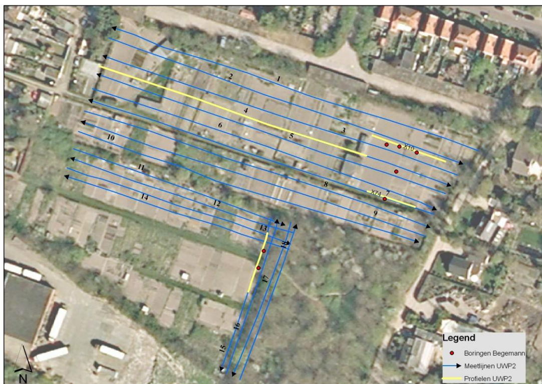
Afb. 16. Locatiekaart met de ligging van de opgenomen 2D georadar meetlijnen en boringen in uitwerkplek UWP 2; zie ook Afb. 1 en 3. De in dit rapport afgebeelde (delen van) meetlijnen zijn in geel weergegeven.
