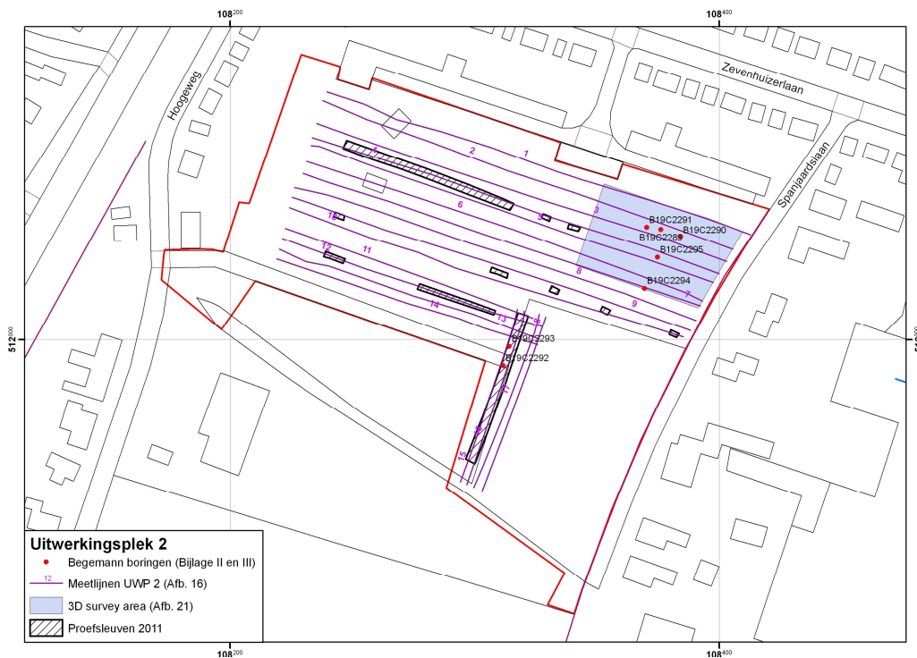
Afb. 3. Locatiekaart van uitwerkingsplek gebied UWP2 met de ligging van de opgenomen georadar meetlijnen, Begemann boorlocaties en proefsleufputten (april 2011).
