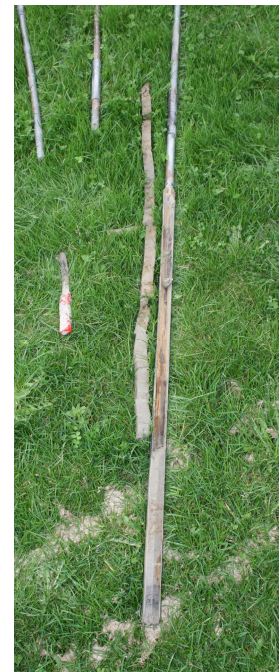
Afb 3. Het gebruikte handboorgereedschap. Op de foto links boort Meindert van den Berg in de bovengrond met de Edelmanboor. De foto is gemaakt langs de Brede Weg, op de achtergrond is de kerktoeren van Kantens waarneembaar. De foto links laat de 1-m lange gutsboor zien. Aan de basis van de gestoken gutskern is de zwarte organische band te zien. De afzettingen daarboven behoren tot de deklaag (kwelderleij).
