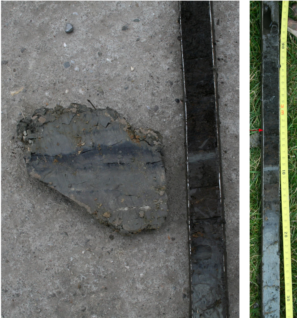
Afb. 6: Vergelijking tussen de geoxideerde zwarte organische band uit het slootkantprofiel (Afb. 4) en het intacte veenniveau in boring 26 in de wierde Stitswerd. Het veen onder de wierde is niet geoxideerd doordat de laag onder de dikke wierde-ophoging afgeschermd was. De rechter foto geeft een beeld van de laagopbouw. Aan de basis komt de blauw grijze klei van het onderste klastische pakket voor die riet doorworteld is. Daar boven komt rietveen voor dat gelaagd is met kleibandjes. Boven de rode pijl begint de wierde ophogingslaag (met o.a. ijzertijd /Romeins aarde werk). Opvallend is dat het ophogingsmateriaal erg organisch is; blijkbaar was er bij de eerste ophoging nog weinig "schone" kwelderleij (van de deklaag) beschikbaar. Dit is het grote verschil met de ophogingslaag van De Grote Knol wierde waar alleen kwelderleij gebruikt is.
