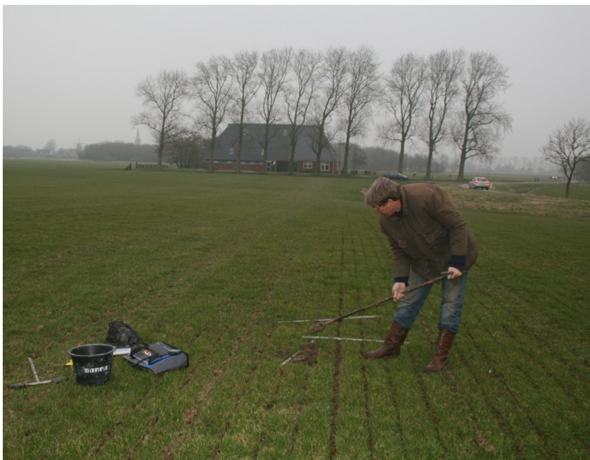
Afb 3. Het gebruikte handboorgereedschap. Op de foto links boort Meindert van den Berg in de bovengrond met de Edelmanboor. De foto is gemaakt langs de Brede Weg, op de achtergrond is de kerktoeren van Kantens waarneembaar. De foto links laat de 1-m lange gutsboor zien. Aan de basis van de gestoken gutskern is de zwarte organische band te zien. De afzettingen daarboven behoren tot de deklaag (kwelderleij).
