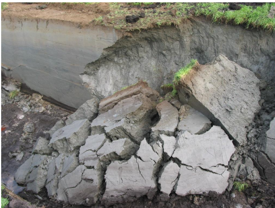
Foto 25: Linkerzijde van het ingestorte profiel op 29-34 m. Aan de basis van de ingestorte Ges-klei komt humeus zand voor. Dat is de bodem van de top van het Pleistocene zand (zie ook onderstaande Foto 26).
