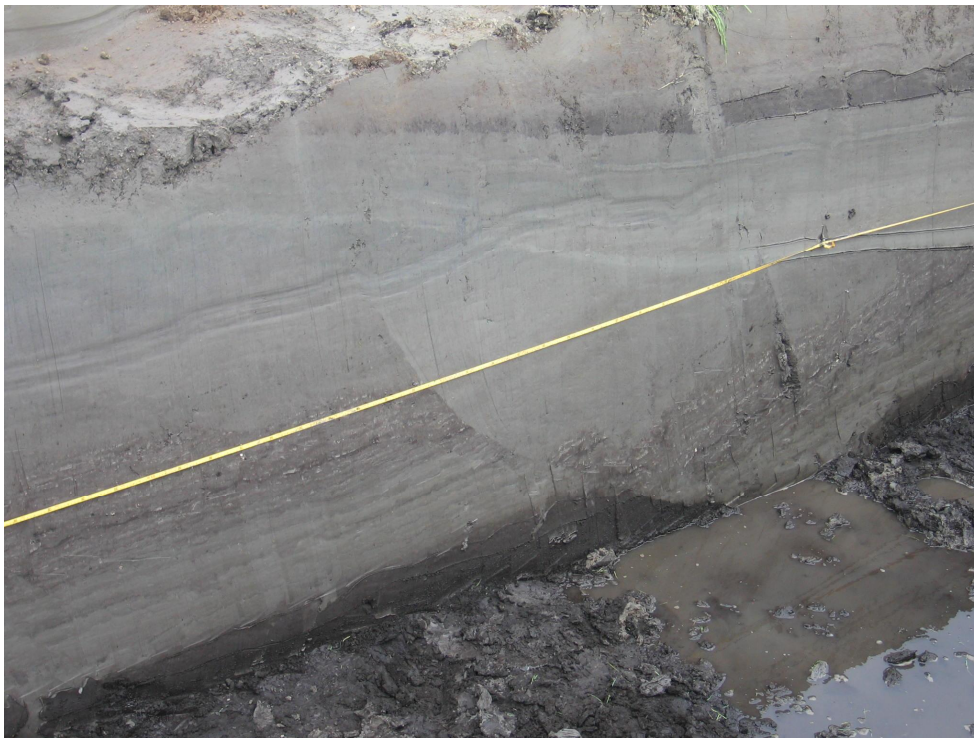
Foto 31: Slumpstructuur op 9-11 m van het geologisch profiel. De humeus gelaagde klei van de lagen 7 en 8 is, met de organogene afzettingen van laag 13, tegen de richting van de klok onderuit gegleden. Deze slump werd veroorzaakt door de erosie van de stroombaan van de Ges. Door de erosie en wegvallen van de tegendruk zijn de lagen 7, 8 en 13 onstabiel geworden en richting stroombaan van de Ges gegleden.
