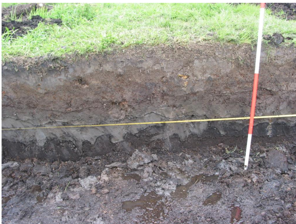
Foto 9: Het geologisch profiel op 61 – 65 m. De top van het veen, net aan de oostzijde van de sloot van de Ges, is sterk verstoord. Op het verstoorde veenoppervlak wig de Ges-klei in oostelijke richting uit. De Ges-klei lijkt in het veen te zijn vertrappt.
