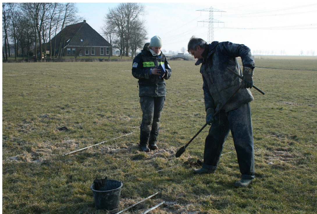
Foto 6: Start van de handboring. De droge, harde bovengrond wordt uitgeboord met de Edelmanboor.
