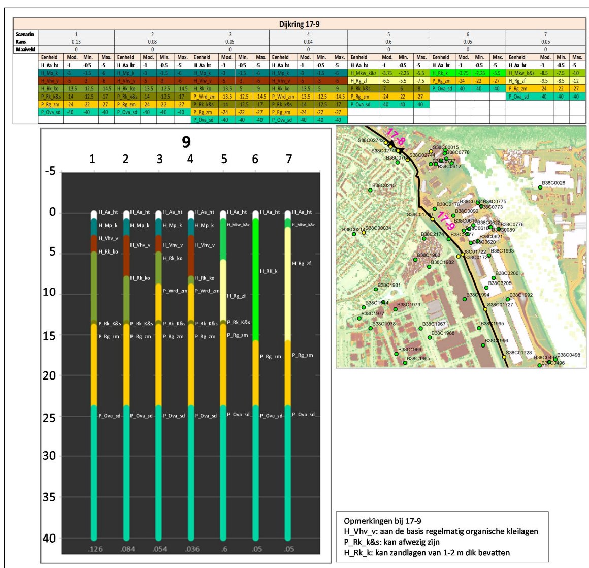
Figuur 5.2 Overzicht van de informatie die het WTI-SOS verschaft. In dit voorbeeld zijn zeven scenario's onderscheiden met een kans van aantreffen. Het bovenste tableau geeft per scenario van elk van de onderscheiden grondlagen de modale, minimum en maximum diepteligging weer. Het tableau linksonder is een weergave 'op schaal' van de grondlagen in de zeven scenario's, het tableau rechtsonder geeft een situatieschets met beschikbare grondonderzoekspunten
